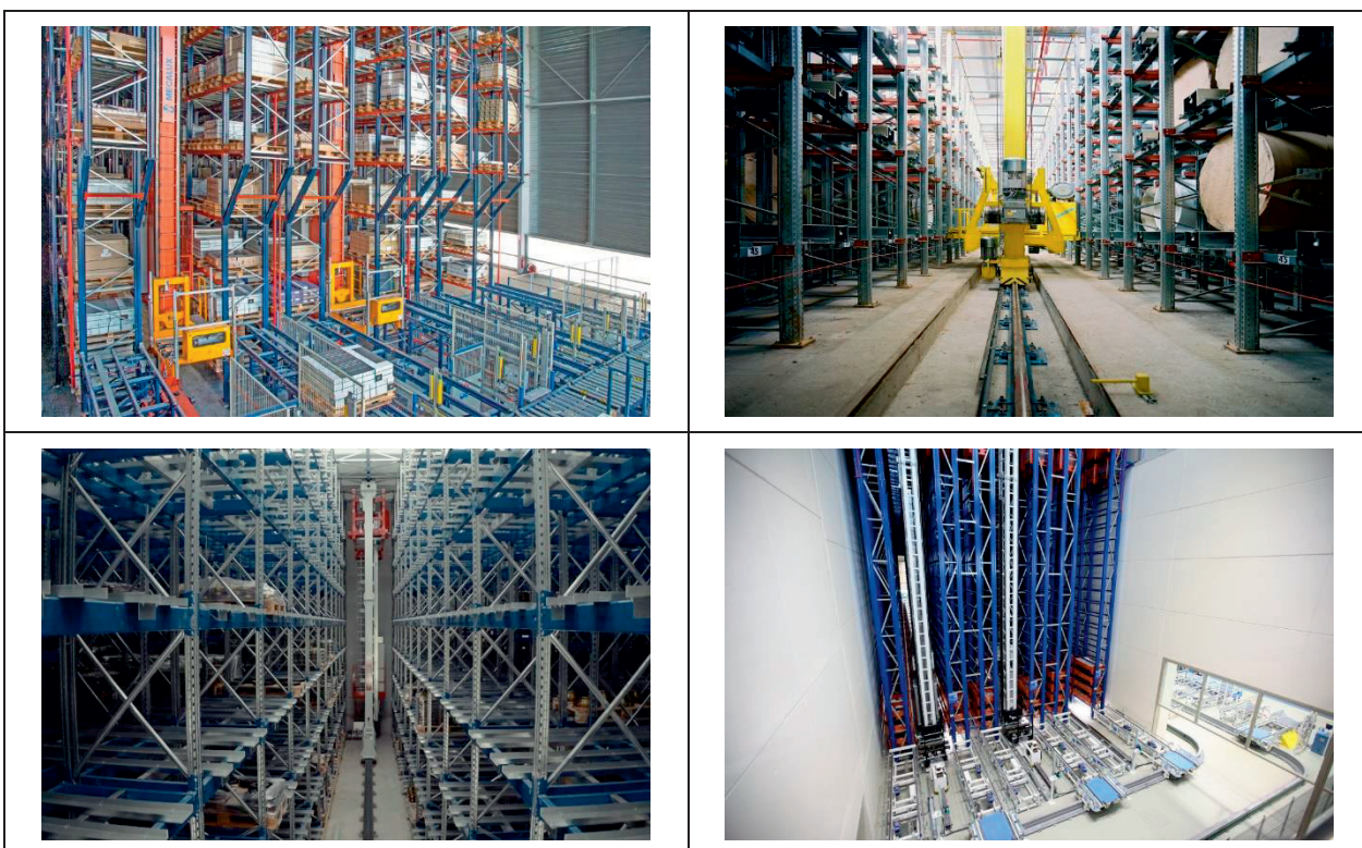
Figura 6.2-3: Scaffalature porta pallet con trasloelevatore - classificazione 5.1.3 UNI EN 15878
